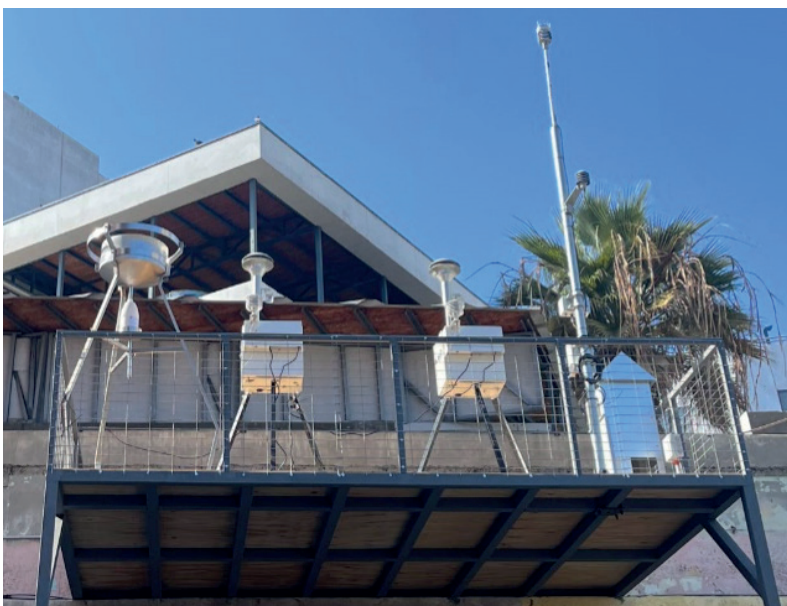
Figura 12. Equipos de monitoreo de calidad de aire y meteorológico instalados en la plataforma.
